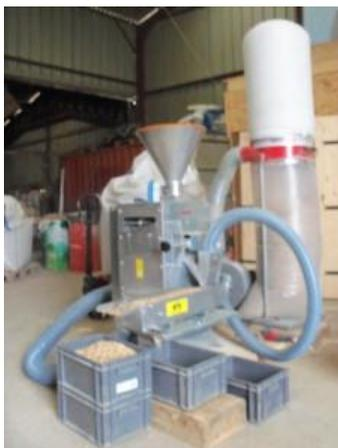
Figure 3 : Photo d'une décortiqueuse électrique à cylindre
